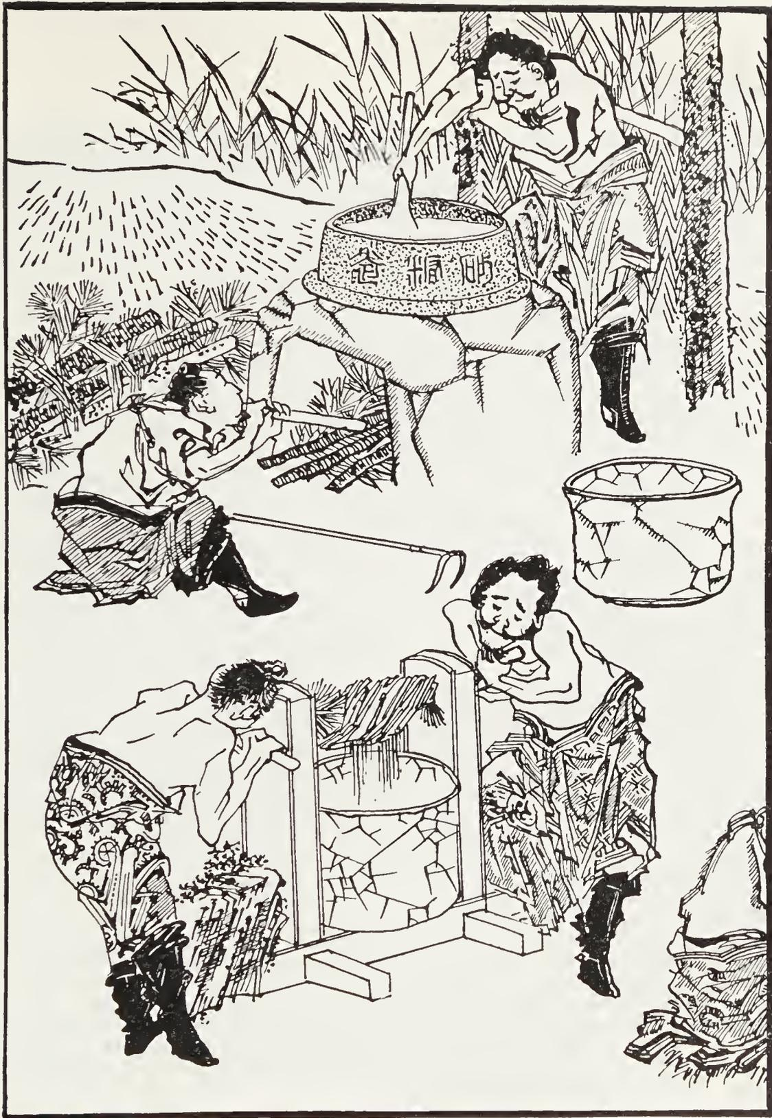
Fig. 74 bis. La fabrication du sucre au Japon, d'après Hokusai (suite) : le suc est exprimé par torsion, ensuite mis à la chauffe.
