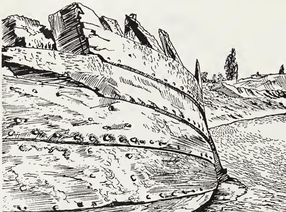
**Fig. 93.** Navire du XV<sup>e</sup> siècle renfloué récemment à Brême. Bon exemple de la construction d'un bordé à clin. Les planches, clouées les unes sur les autres, se recouvrent comme les ardoises d'un toit. (D'après le *Courrier des Messageries maritimes*.)
